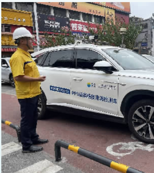
PPB级高精度泄漏检测车正在工作。
