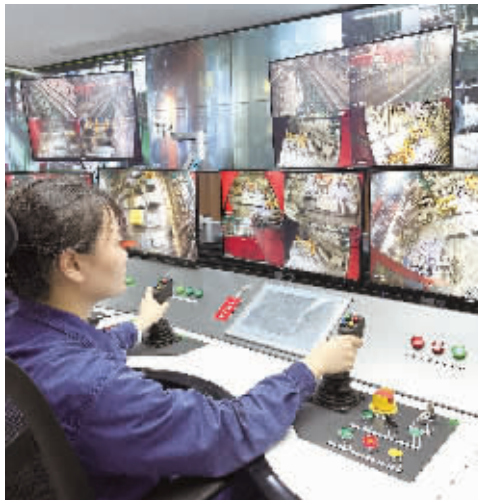
在湘钢五米宽厚板厂智慧中心，工作人员依托5G技术+智能化技术，通过手柄、按键遥控炼钢、轧制、成品、入库等各道工序。
