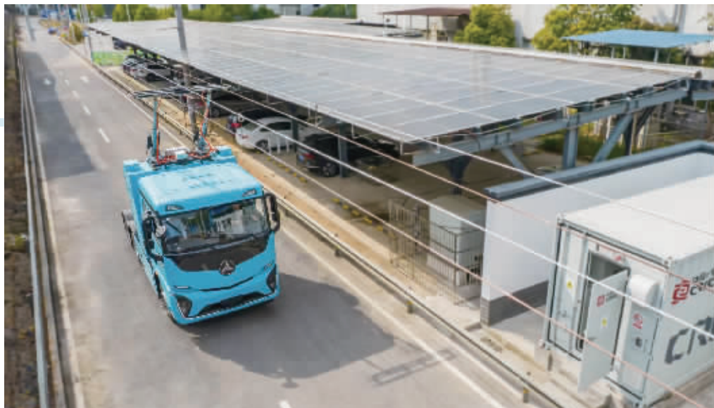
株洲电气化公路示范线。 通讯员 摄
