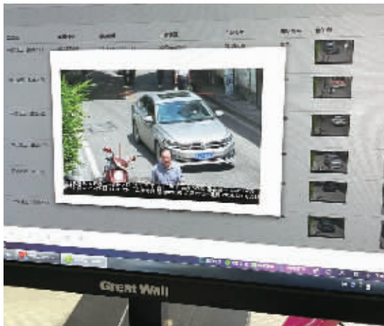
乔庄社区智慧安防系统中的摄像头可清晰记录每辆车进入辖区的时间、位置,同时记录该车车型、颜色、车牌等信息。
