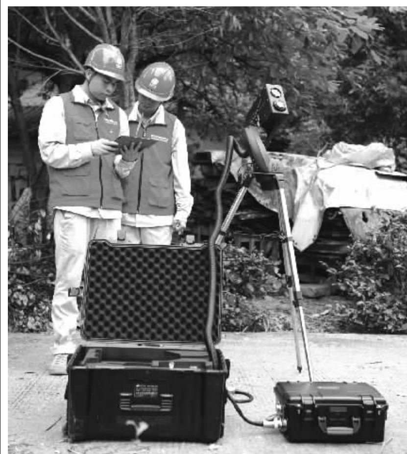
运维人员在应用“激光炮”清除树障。
