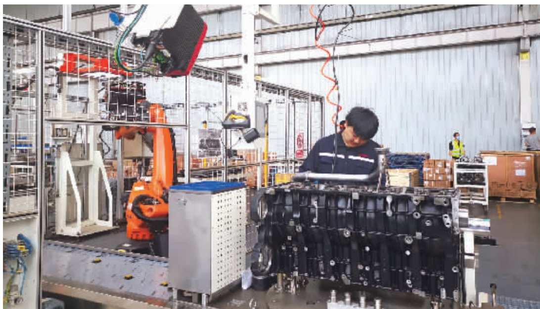
在长沙三一依茨发动机生产线上，工作人员正在检查发动机辅助件的拧紧情况。 记者 卜岚 摄
