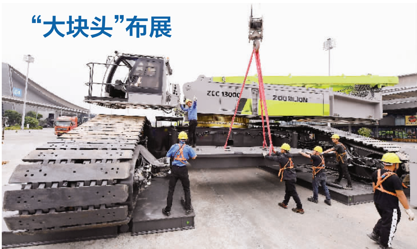
5月6日,长沙国际会展中心,技术人员在组装中联重科ZCC13000超大型履带起重机,这是今年长沙国际工程机械展迎来的首台参展设备。这台履带起重机是中联重科4.0产品,高178米、额定起重量220吨。2021长沙国际工程机械展将于本月19日至22日举行。
