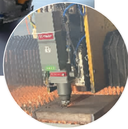
►湖南大科激光有限公司生产车间,一台激光器正切割一块厚50毫米的碳钢板。 记者 周可摄
