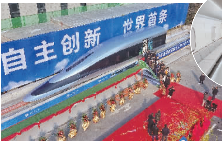
时速620千米!1月13日,世界首台高温超导高速磁浮工程化样车在成都下线。这是1月12日拍摄的高温超导高速磁浮工程化样车内观、外观及试验线。 新华社图
