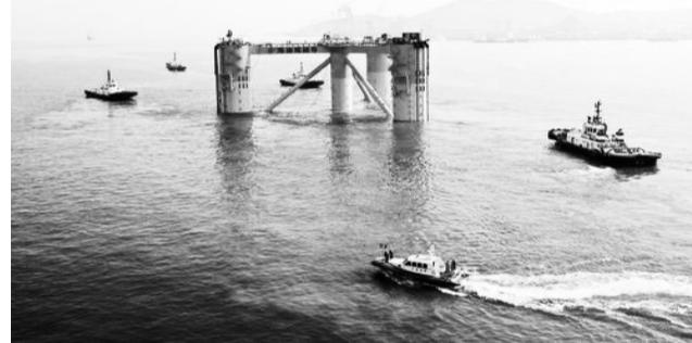
近日,由海洋石油工程(青岛)有限公司建造的我国首个深远海浮式风电平台——“海油观澜号”从青岛西海岸新区顺利启运。该平台将安装于距海南文昌136千米的海上油田海域,为全球首座水深超100米、离岸距离超100千米的“双百”海上风电项目。项目投产后,风机所发电力通过动态海缆接入海上油田群电网,用于油气生产,年发电量可达2200万千瓦时,减少二氧化碳排放2.2万吨。
