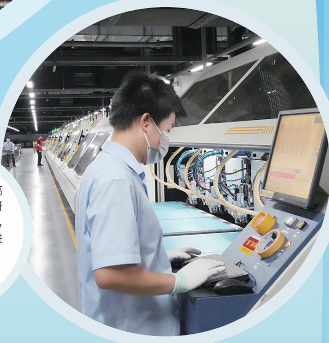
在明正宏高频高速PCB智能制造研制项目生产车间内，工人正在操作机器进行打孔。 张佳玉 黄彩燕 摄
