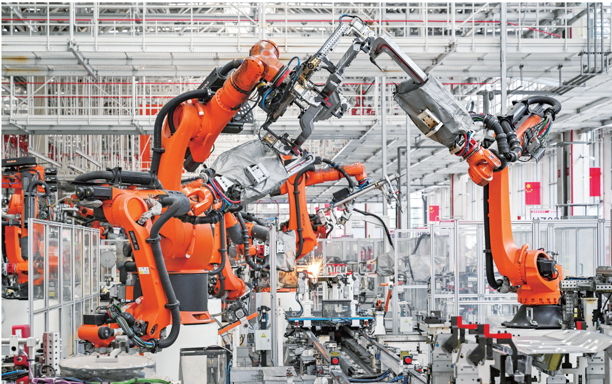
三一重卡智能制造生产车间，自动机器人在冲压、焊接、涂装、总装等核心环节全流程协同作业，大幅提升生产效率与制造精度。(资料照片)
