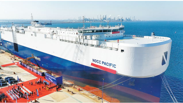
由中集来福士为挪威建造的7000车位LNG双燃料汽车运输船“NOCC PACIFIC”号11月14日在山东省龙口市完工并举行命名仪式。该船针对新能源汽车运输安全做出了专门设计，可满足将于2026年1月1日起强制实施的《国际海运危险货物规则》第42-24修正案要求。图为当日在中集来福士集团龙口建造基地拍摄的“NOCC PACIFIC”号汽车运输船（无人机照片）。 新华社 发
