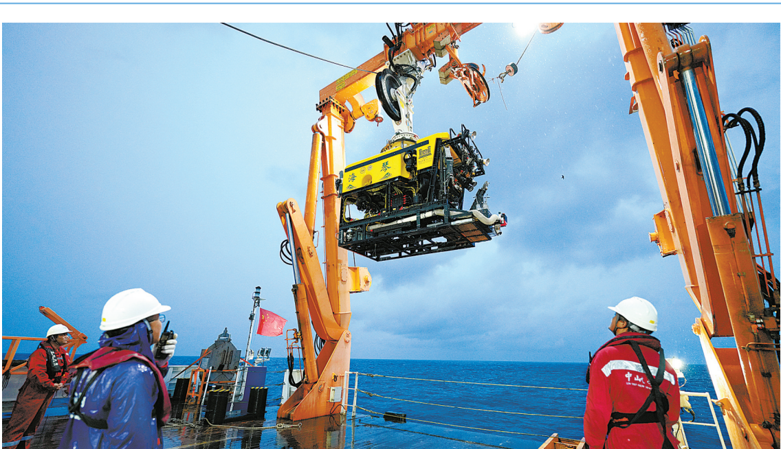
8月23日清晨,在南海的晨曦中,我国自主研制的6000米级深海无人遥控潜水器(ROV)“海琴”号,经过8个小时作业,从4140米深海凯旋,成功进行海试,我国深海研究又多了一个“科考利器”。“海琴”号搭载了高清摄像机、多功能机械手、探测传感器等科考设备,具备自动定向、悬停定位、自动巡线等智能作业能力。图为当日拍摄的“海琴”号从海里回收时的情景。
