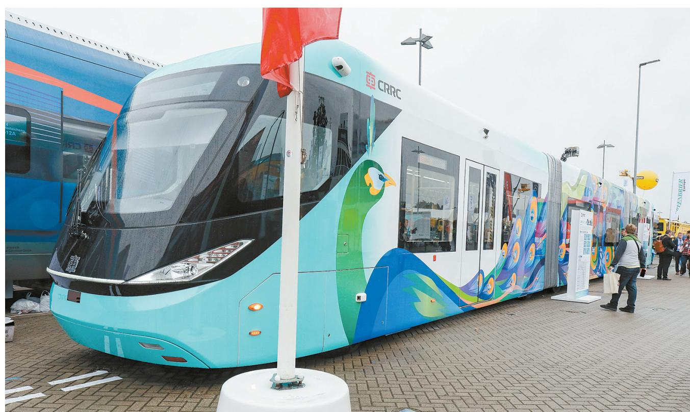
当地时间9月24日开幕的2024年德国柏林国际轨道交通技术展览会上，中车株洲电力机车研究所有限公司自主研制的智能轨道交通快运系统2.0版本“绿宝石号”首次亮相。除核心的虚拟轨道自动驾驶控制技术外，它还运用了智能驾驶等前沿技术，可在城市道路上全自动驾驶。
