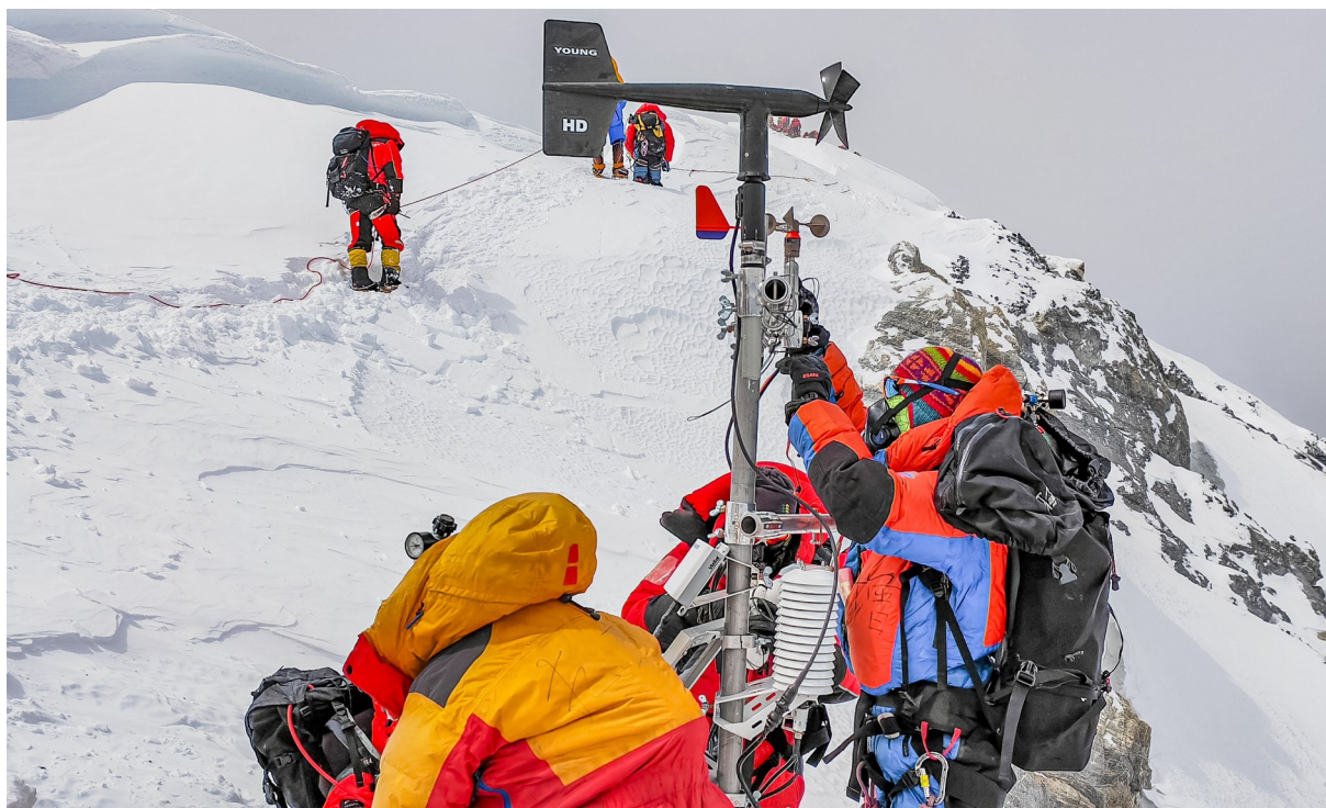
科考登顶队员在珠峰海拔约8830米处维护升级自动气象站(5月23日摄)。新华社发
