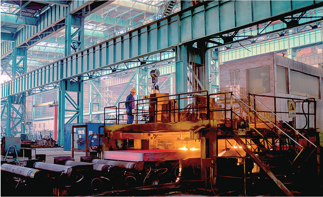
湘钢五米宽厚板厂连铸车间，工人正在进行钢坯切割作业。
