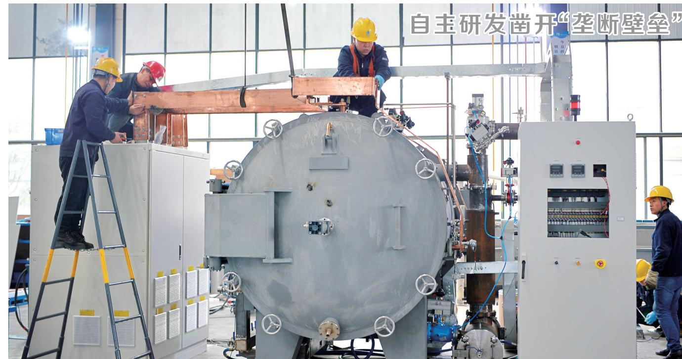
4月1日,长沙经济技术开发区湖南顶立科技有限公司,工人在组装3300°C超高温真空纯化炉。该超高温真空纯化炉由顶立科技自主研发,是国内目前温度最高、尺寸最大的真空高温设备,打破了西方国家在超高温设备对我国的垄断和“卡脖子”技术封锁,填补了国内空白。
