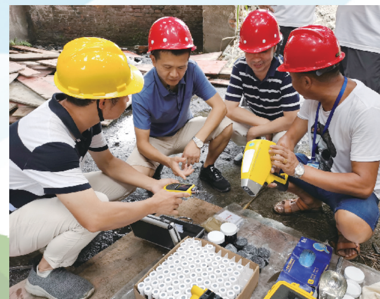
重点行业企业用地土壤污染调查有机污染物现场检测。
