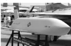
“该导弹通过雷达隐身和红外隐身设计,大大减少了被探测的可能。”远望智库研究员、军事专家张文昌表示,一是大量使用复合材料,减少雷达反射和红外反射。二是通过气动外形的设计,如弹头设计成菱形,可有效减小雷达波沿原路返回的能量。此外,发动机的进气道也进行了隐身设计,发动机尾喷口采用遮挡技术,减小被雷达和红外系统发现的概率。三是采用隐身涂料,AGM-158B的雷达反射面仅0.1,一般雷达很难探测到。
