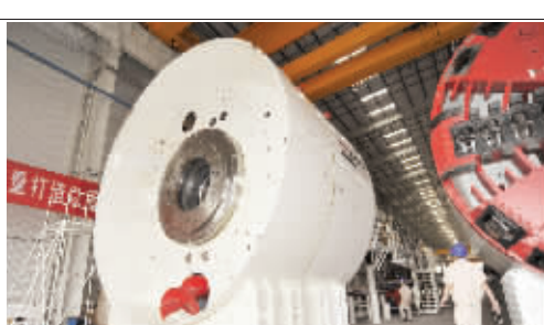
6月28日,中铁轨道系统集团有限公司,一台盾构机正在进行最后的调试。 记者 田超 摄
