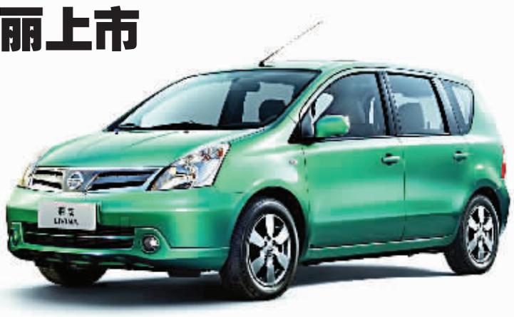
HR16DE全铝发动机,其最大功率为77千瓦,最大扭矩为150N·m,分别搭载5挡手动和4挡自动变速箱,完全满足了消费者的使用需求。在新款车型的车身尺寸方面,新骊威的长宽高分别为4178mm、1690mm、1565mm,轴距达到2600mm。后备厢拥有353L的储物空间,而将后排座椅整体放倒后,储物空间将暴增到1548L,从而营造了同级别车型中最为宽敞舒适的内部驾乘空间,不但能兼顾商用与家居的全方位要求,还能为全家郊游出行
