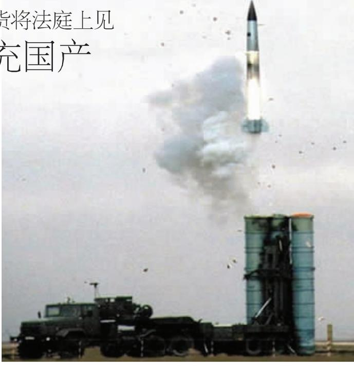
俄制S-300PMU防空导弹发射系统。
