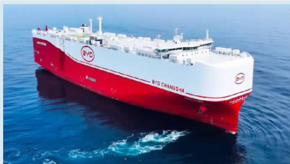
6月24日,比亚迪第6艘汽车运输船“BYD CHANGSHA”长沙号在江苏启航。9200个标准装载车位,全球最大LNG双燃料汽车运输船之一,载着比亚迪汽车驶向全球。比亚迪 供图
