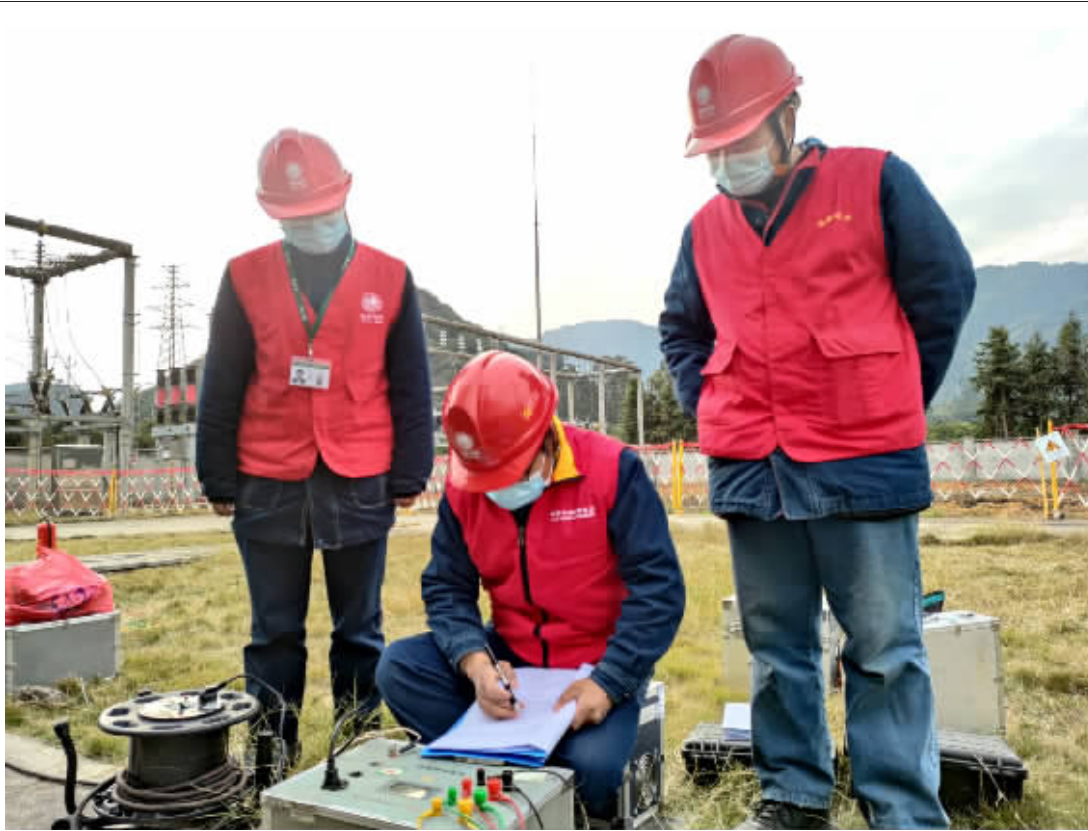
12月17日,国网永州变电检修公司东方红(映山红)共产党员服务队在35千伏舜帝陵变电站结合主变压器更换工作,对新投运主变压器开展绝缘电阻、介质损耗、短路阻抗等试验。通过对该变压器进行全方位“体检”,保证主变压器零缺陷投运。投运后站内1号主变压器容量将由6300千伏安增至10000千伏安,大大提升该站的负荷承载力,为电网迎峰度冬和春节期间的电力供应提供可靠保障。 ■ 摄影 / 撰文 孙梅 周爱远
