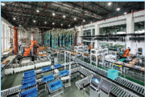
国际领先的电表全自动智能检定与仓储一体化系统。
