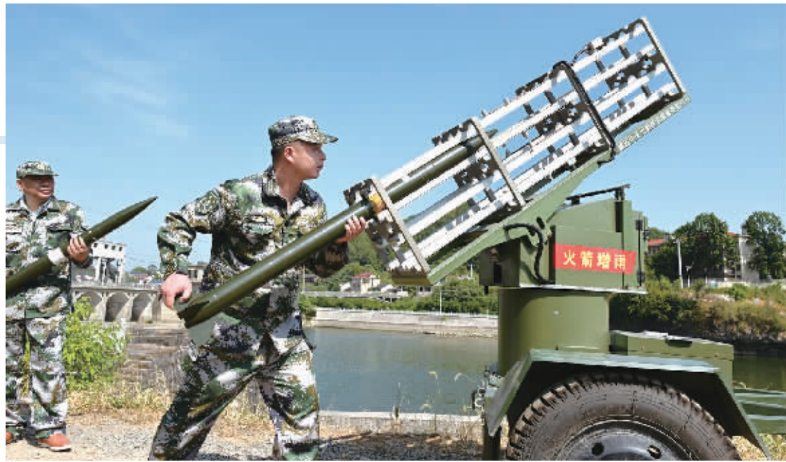
8月17日，洞口县黄桥镇三角村，人工影响天气作业分队的民兵在装弹进行人工增雨作业。滕治中 摄
