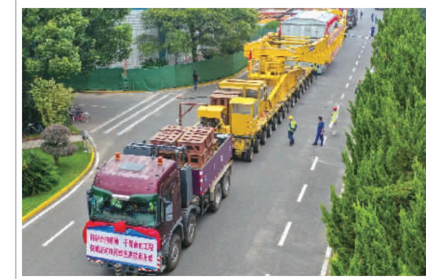
8月16日，特变电工衡阳变压器有限公司为1000千伏南昌至长沙特高压交流线路工程研制的长沙站首台1000千伏变压器机组成功发运。该公司承接了该工程长沙站7台ODF-PS-1000000/100主变压器的研制任务，首台1000千伏变压器的各项技术参数及性能指标均优于国际先进水平。 彭斌 摄
