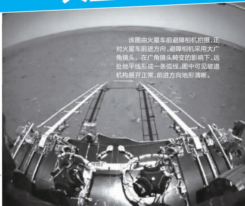
5月19日,国家航天局发布我国首次火星探测天问一号任务探测器着陆过程两器分离和着陆后火星车拍摄的影像。图像中,着陆平台和“祝融号”火星车驶离坡道、太阳翼、天线等机构展开正常到位。
