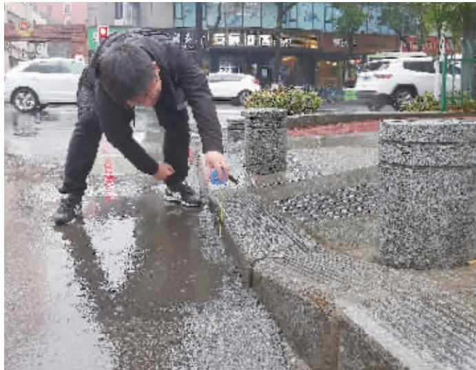
记者在竹园路路口处实地测量缘石坡道坡口与车行道的高差。
