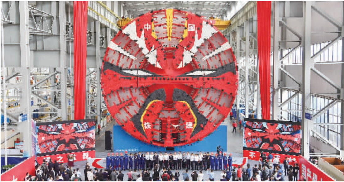
9月27日,一台最大开挖直径达16.07米的超大直径盾构机在中国铁建重工集团长沙第一产业园下线。湖南日报首席记者 郭立亮 摄
