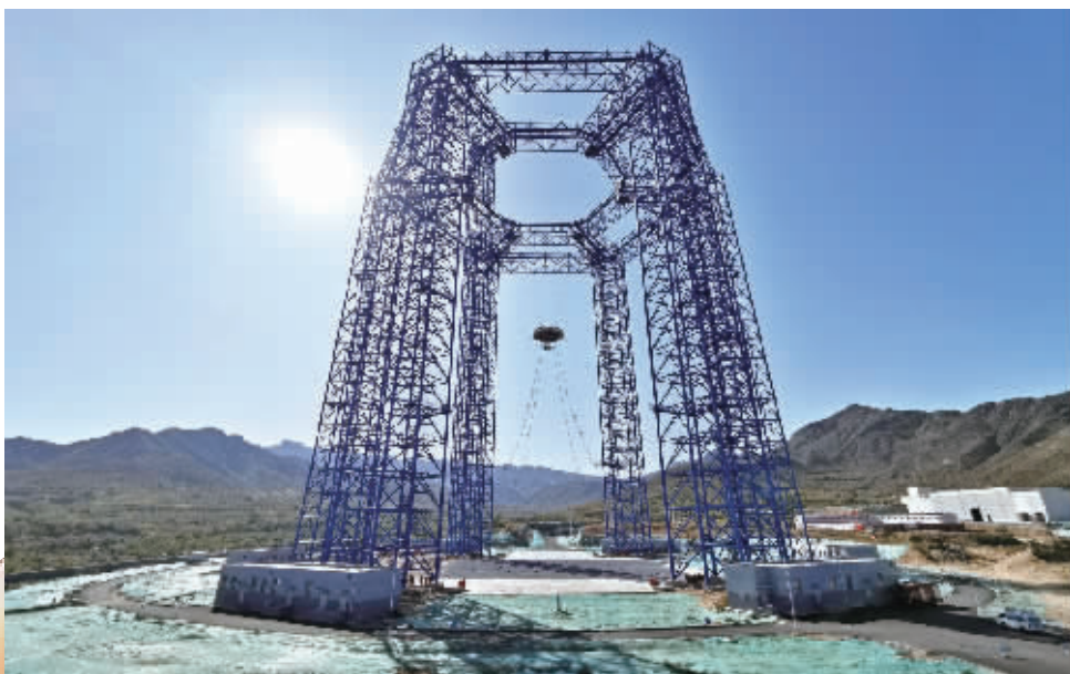
中国首次火星探测任务着陆器悬停避障试验现场。图 国家航天局
