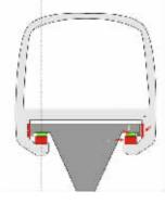
你可以简单的把1和2 想象成磁铁的N和S极,两 者间产生吸力, 使得列车 向上"浮"起来,而3的作用 则是保证列车不会在运行 中与轨道碰撞, 同时可以 对列车进行导向制动。
