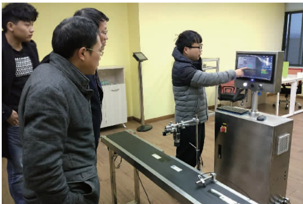
刘浪正在进行喷码标识质量检测系统的演示。
