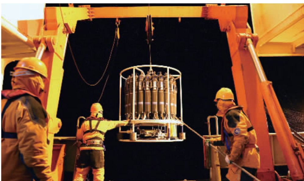
科考队员进行舢部甲板回收CTD(海水温盐深剖面仪)作业(3月2日摄)。搭载中国第34次南极科考队的“雪龙”号极地考察船目前正在南极阿蒙森海进行科考调查作业。
