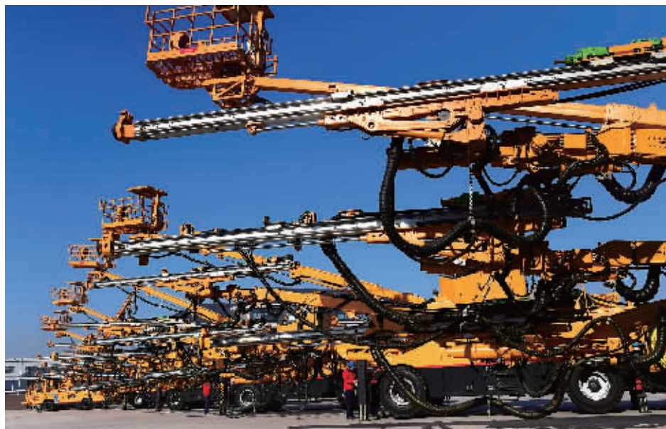
12月22日，中国铁建重工生产的全电脑三臂凿岩台车，可全自动高效智能化钻孔，填补了国内空白。 记者 郭立亮 摄
