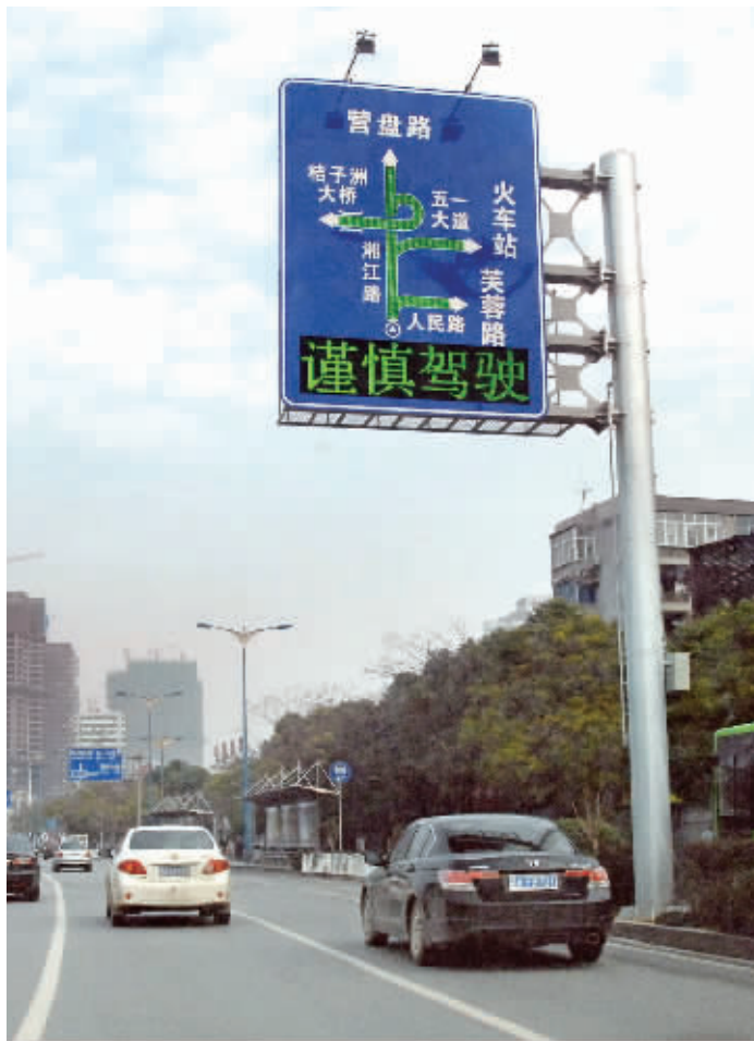
车辆从长沙市湘江路新安装的交通诱导电子指示牌下通行。指示牌通过感应自动计算车流量,采用文字和图形发布诱导信息,提示司机选择合理路线行驶。(资料图片)
