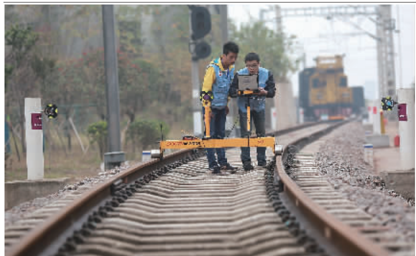
11月7日，选手在进行轨道精测精调作业。当天，“南方高铁杯”第三届全国职业院校高速铁路精测精调技能大赛在湖南高速铁路职业技术学院开赛，来自全国24所职业院校的170余名选手同场竞技，一较高下。 刘晓飞 向吟吟 摄影报道
