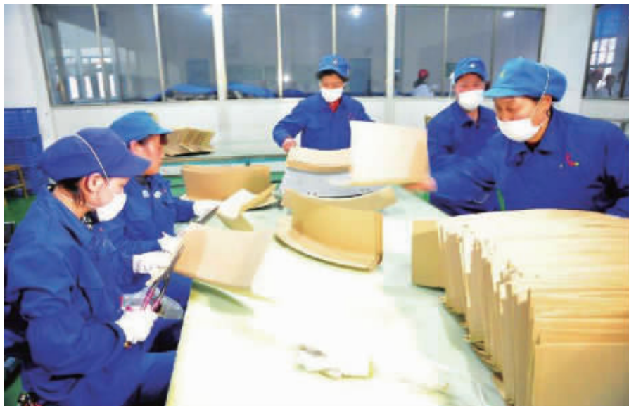
广信科技员工正在生产绝缘纸板配件。
