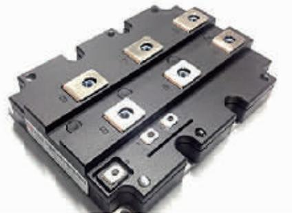
中车时代电气研发的3300V/1500A高功率密度IGBT实现了低功耗、高可靠性的突破,具有比竞争对手更低的导通压降特性。
