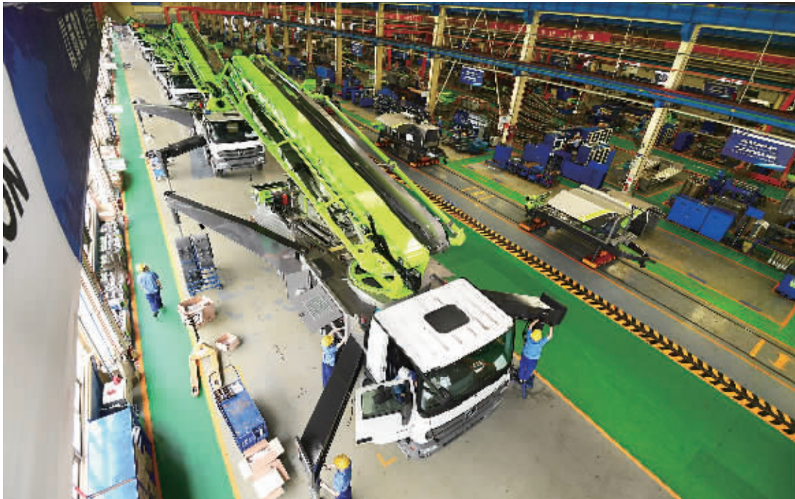
5月15日，中联重科麓谷工业园，一批高精高效56米混凝土泵车在装配车间即将下线。
