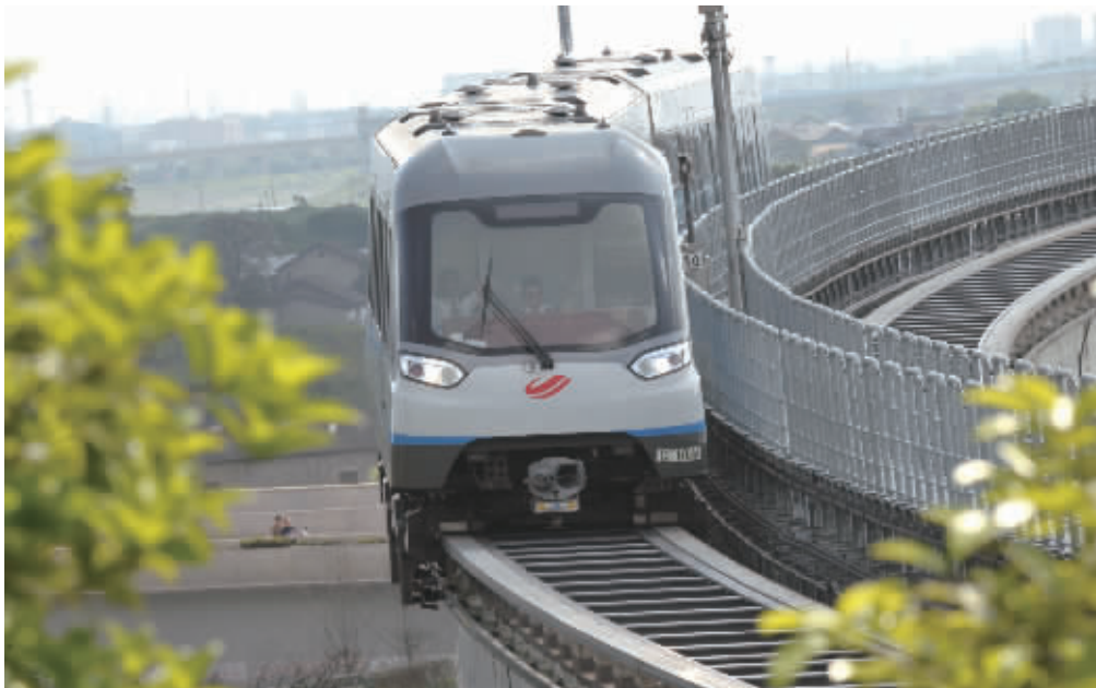
5月6日,长沙磁浮快线安全试运营一周年。这是我国首条中低速磁浮铁路,使用的磁浮列车由中车株洲电力机车有限公司与国防科技大学等高校自主研发生产。据湖南磁浮公司统计数据显示,2016年5月6日至2017年5月5日,长沙磁浮快线累计发送旅客2599762人次。 新华社 图
