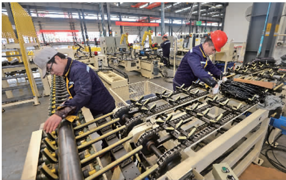
湘潭九华经济技术开发区泰富重装二期生产基地内,工作人员在安装、调试智能托辊生产线的运输设备。 记者 李健 摄
