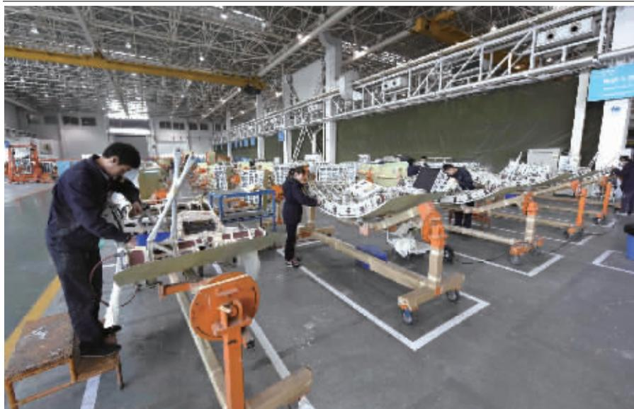
3月3日,在中航工业成飞民用飞机有限责任公司,工人们在A320前后登机门装配生产线上。近日,公司向空客公司顺利交付A320系列飞机首架前登机门、第3000架后登机门。
