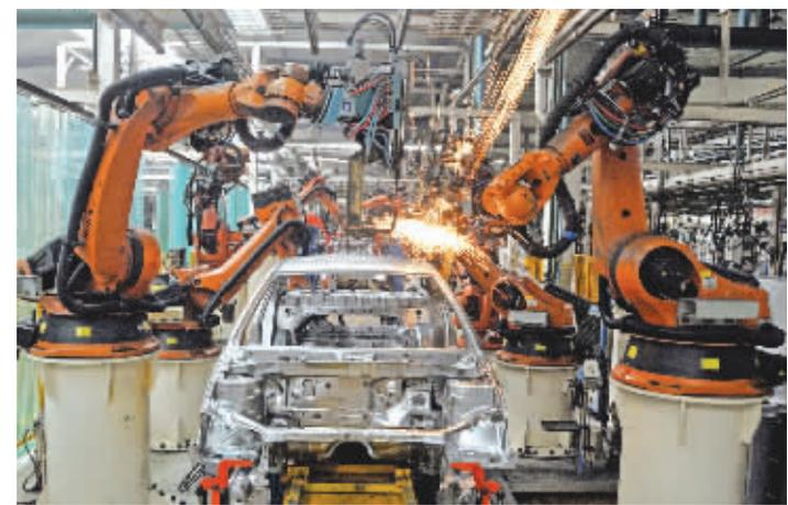
吉利汽车焊装车间自动化生产线。
