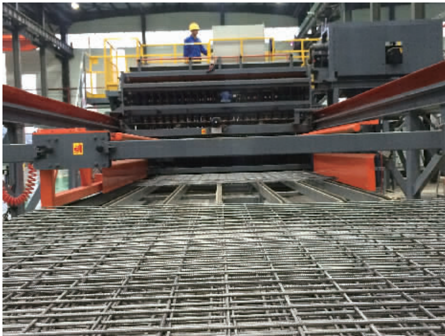
在中建科技宁乡产业园的生产车间，扎钢筋由机械自动完成。
