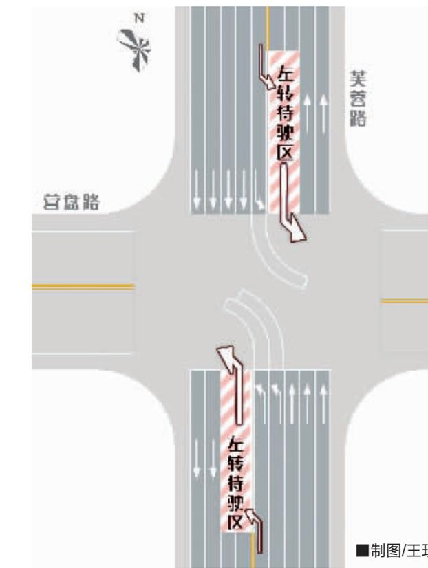
畅(特别是南北出口),极可能发生出口积压车辆占用新设借道左转车道,使左转车辆无法进入新设借道左转车道。
