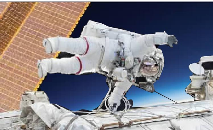
太空行走,给机械臂加润滑油,给载人飞船的对接端口铺电缆,修复冷却系统。
