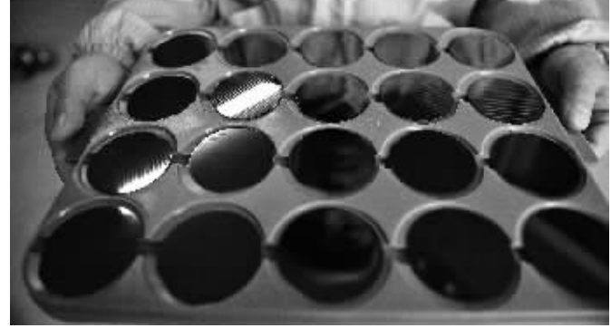
“硅衬底高光效GaN基蓝色发光二极管”获国家技术发明奖一等奖。图为加工好的硅衬底,研究团队就要在这个衬底上“生长”蓝光LED材料。
