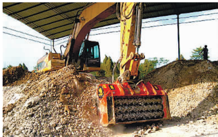
从芬兰引进的土壤破碎筛分车，每天可处理污土300方。
